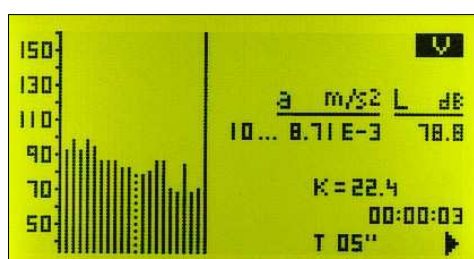
Affichage graphique par bande de tiers d'octave (1 Hz à 80 Hz) et évaluation de k
