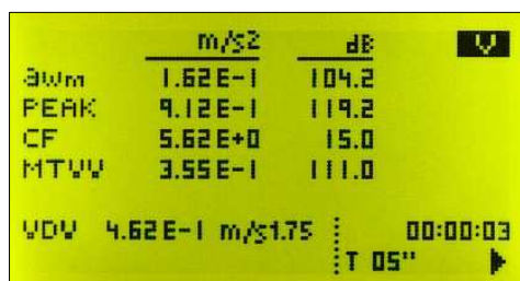
Affichage de paramètres d'évaluation globaux conformément ISO 2631-2:2003
